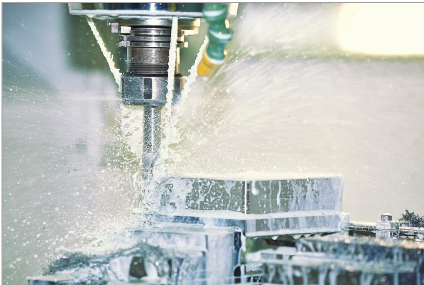
Abb. 5: ‚Wasserkühlung als System‘ eignet sich für anspruchsvollste Anwendungen, z.B. Fräsmaschinen mit Präzisionsspindel, bei denen sich eine unpräzise Kühltemperatur negativ auf die Fertigungstoleranzen des Werkstücks auswirken würde.
